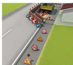
SEGNALETICA LAVORI STRADALI
