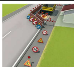
SEGNALETICA LAVORI STRADALI
